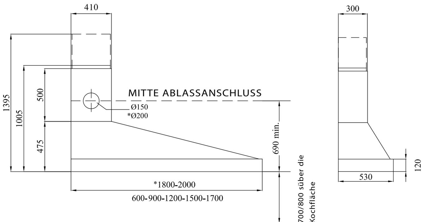
Die Abzugshaube nicht in einem kleineren Anschluss als vorgesehen anschließen. Es besteht die Gefahr von Fehlfunktionen und Überhitzung des Motors. Wenn die Realisierung den Abluftanschluss  $\varnothing$  200mm (1200mc/h) nicht möglich ist, wie Standard vorgesehen (KD180-200), es wird empfohlen die Abzugshaube mit einem  $\varnothing$  150mm (900mc/h) Motor anzufordern.
